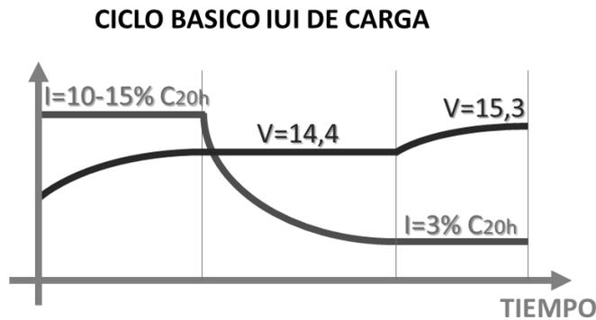
para alcanzar una recarga completa es del tipo IUI, con 3 etapas: La primera "I" de corriente constante, la segunda "U" de voltaje constante y la tercera "I" de corriente constante (ver figura). Para la etapa inicial de corriente constante, se recomienda una corriente máxima de 10-15% de la capacidad nominal de la batería ( $C_{20h}$ ) y vigilar que el voltaje creciente no supere el valor
