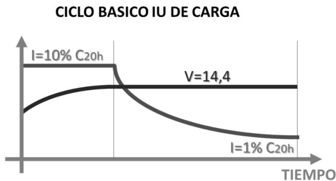
del tipo IU, con 2 etapas: La primera "I" de corriente constante y la segunda "U" de voltaje constante (ver figura). Para la etapa inicial de corriente constante, se recomienda una corriente máxima de 10% de la capacidad nominal de la batería (C20h) y vigilar que el voltaje creciente no supere el valor máximo de 14,4V (2,4V por celda). Para la etapa siguiente de voltaje
